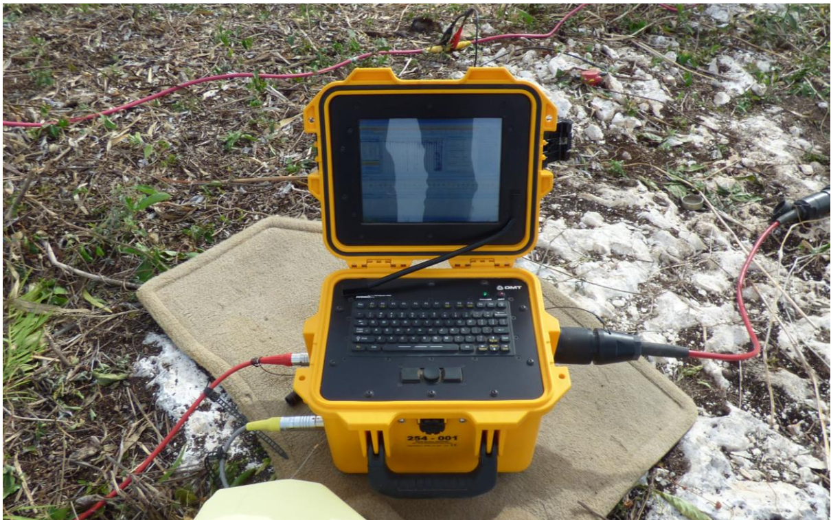
Vista de la pantalla del sismógrafo en campo donde se observa la llegada de las ondas sísmicas.
