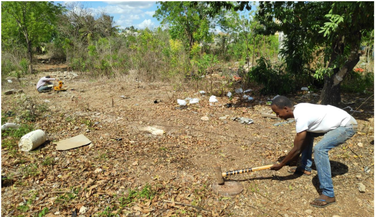
Ayudante golpeando placa de metal a lo largo de la línea Vs01.
