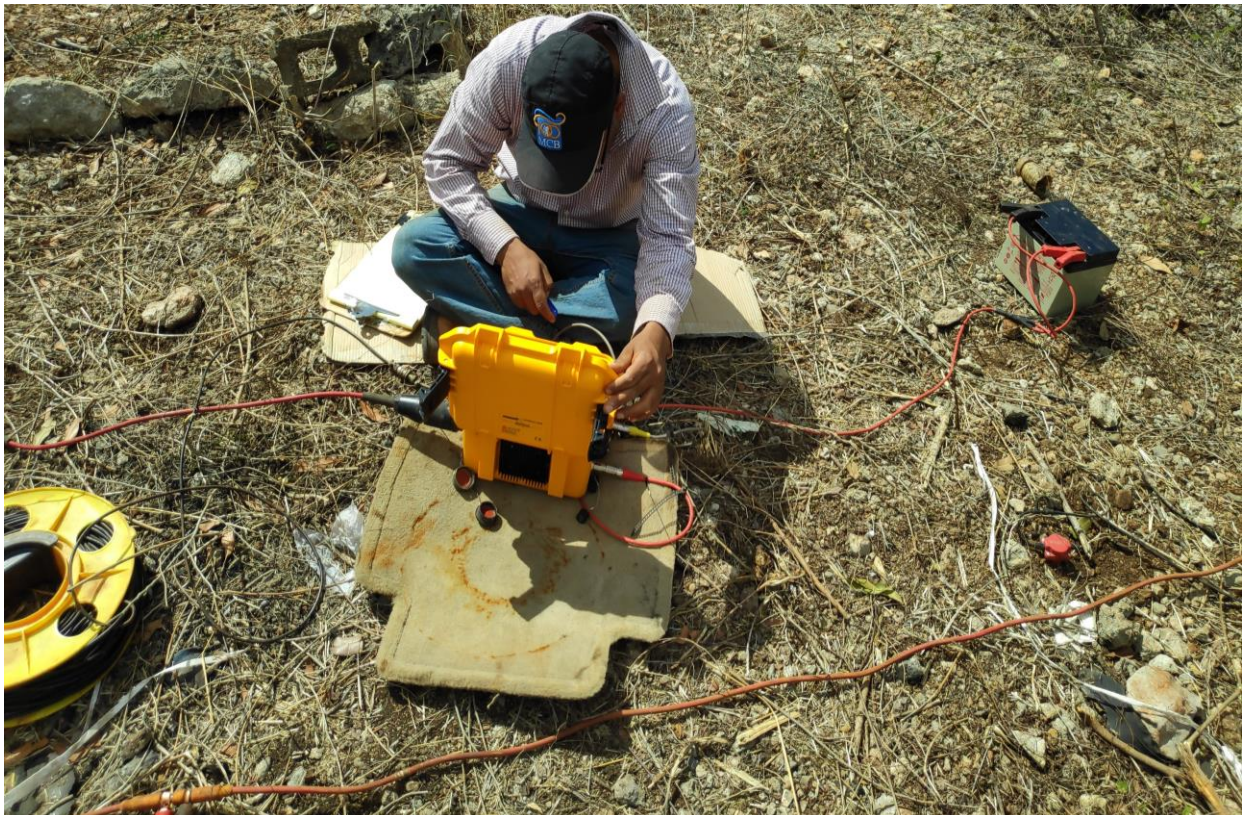
Proceso de medición de velocidades de ondas sísmicas en el sitio para hospital en Villa Hermosa.
