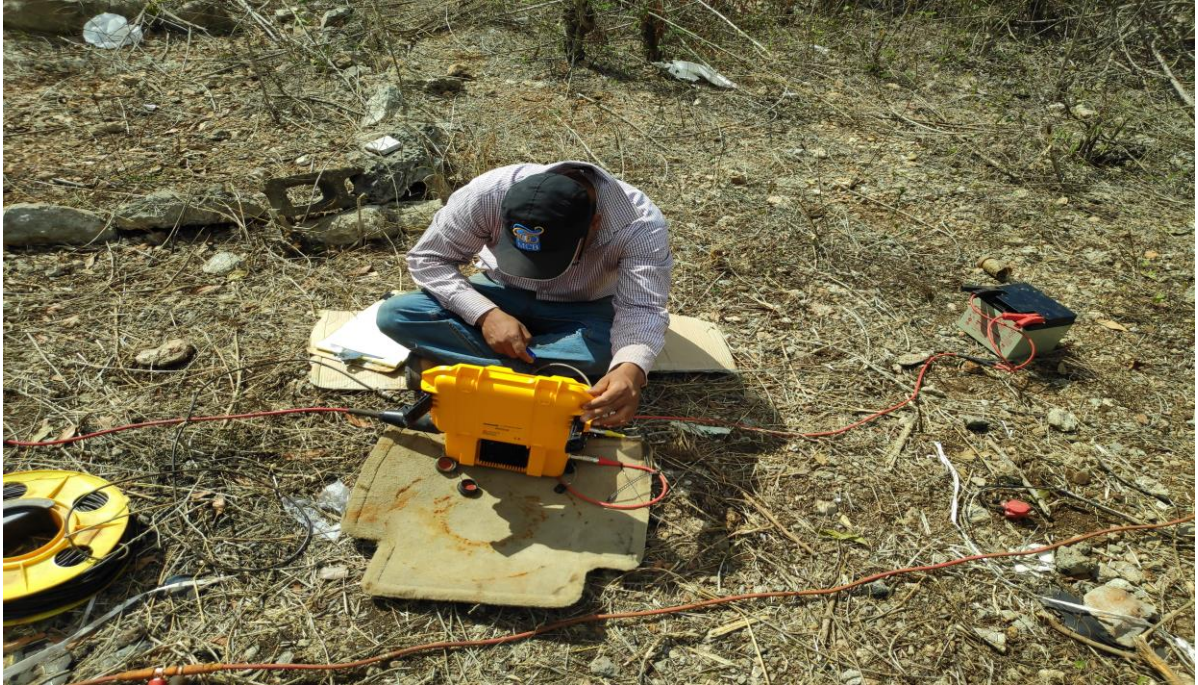
Operador con el moderno sismógrafo DMT Summit Extreme Pro, operando a lo largo de las líneas Vs 01.
