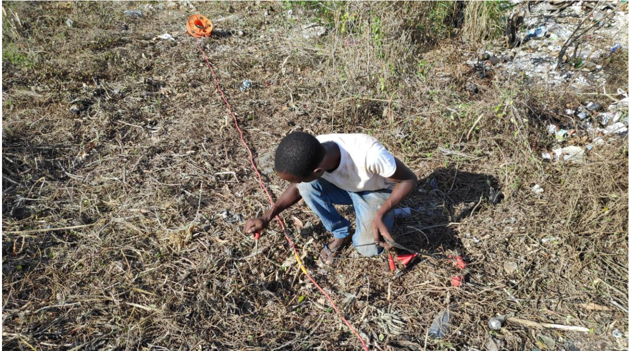
Ayudante desconectando geófonos para avance en la línea
