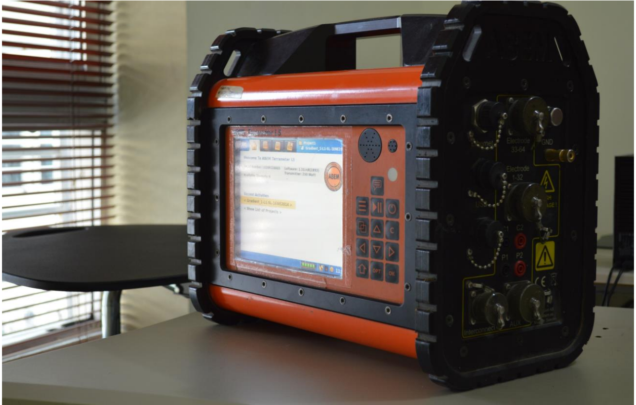
Moderno sistema de Resistividad Eléctrica Terrámetro LS.
